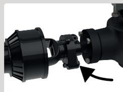
Controle limitador de torque, com sistema de pino fusível de proteção contra travamento.
